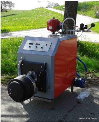
Durchlauferhitzer mit Röhrenwärmetauscher direkt im Heizkesselwasser
