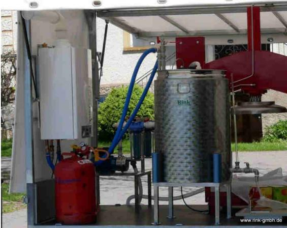
Zu empfehlen, wenn kein 400V-Anschluss verfügbar ist. Direkterhitzung vom Saft in wärmeisoliertem Edeltank.
