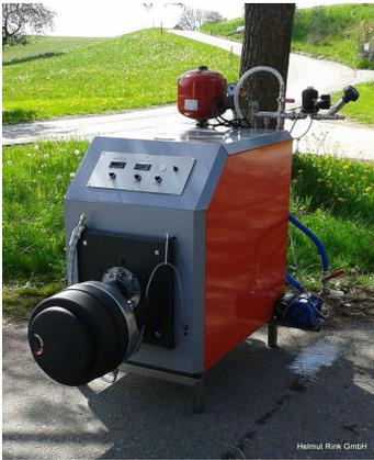
Durchlauferhitzer mit Röhrenwärmetauscher direkt im Heizkesselwasser
