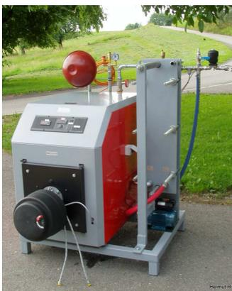
Plattenwärmetauscher (PK) haben folgende Vorteile:
