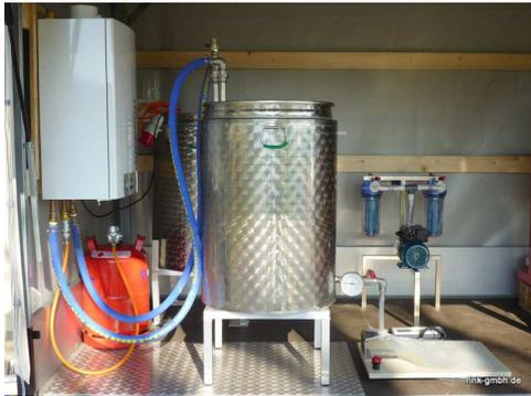
Zu empfehlen, wenn kein 400V-Anschluss verfügbar ist. Direkterhitzung vom Saft in wärmeisoliertem Edeltank.
